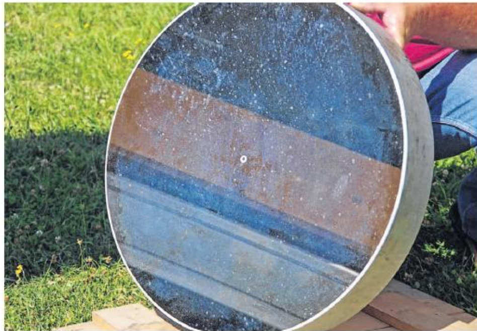
Feuchtigkeit und wechselnde Temperaturen haben dem Hauptspiegel des Johann-Kern-Teleskops der Johann-Kern-Sternwarte in Reicholzheim arg zugesetzt. Deshalb wird nun die Spiegeloberfläche wieder aufpoliert. BILDER: JOHANN-KERN-STERNWARTE
