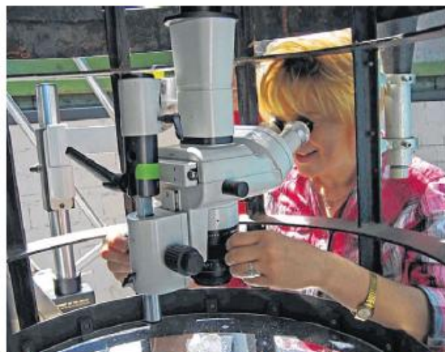
Die Oberfläche des beschädigten Spiegels wurde eingehend von Gabriele Maas vom Fraunhofer Institut für Siliciumforschung untersucht.
